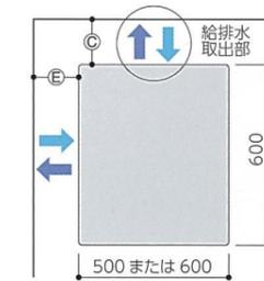
◎:配管施工面は、壁面より150～200mm空けてください。
